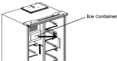
یخ موجود در جایخی ممکن است به دلیل تجمع یخ یا دلایل دیگر، خروجی را مسدود کند. در این حالت جایخی نیاز به تمیز کردن یا از بین بردن توده یخ دارد.
