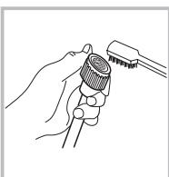
چنانچه میزان ورودی آب کم است نسبت به تمیز کردن فیلتر اقدام نمایید.
