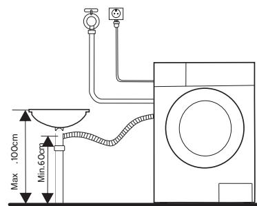
نصب با قطعه عصایی شکل به لبه ظرفشویی
